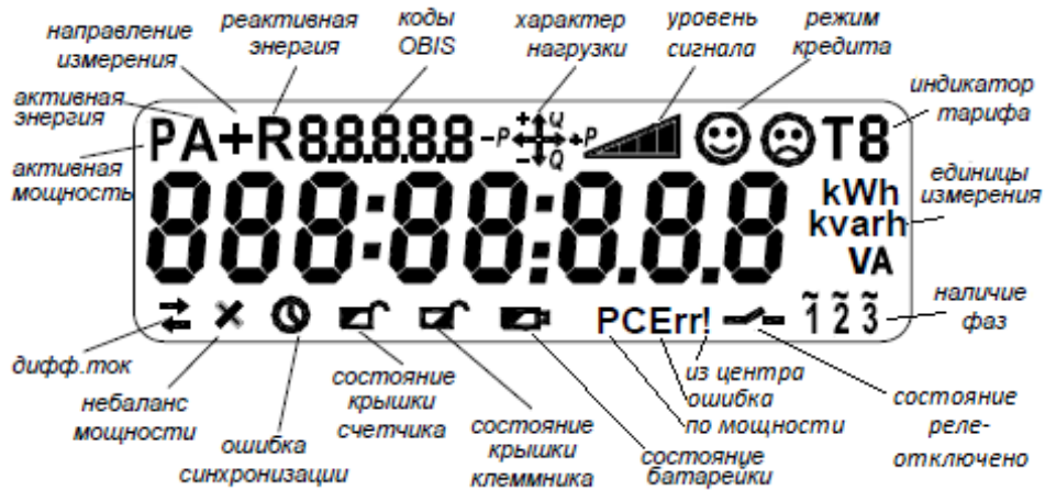
Рис. 4.1. Вид стандартного дисплея счетчика. В тестовом режиме все сегменты активны.
