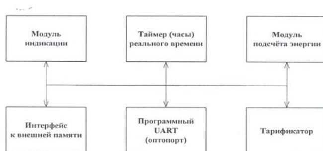
Рисунок 5 - Структура программного обеспечения «Меркурий 234»
