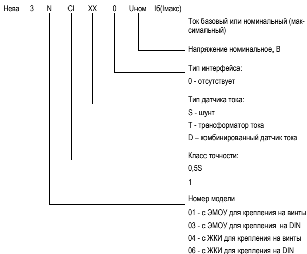
Рисунок 2 Структура условного обозначения счётчиков НЕВА
